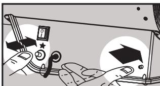
3. Нажмите кнопку подачи газа и, держа её в нажатом состоянии, многократно нажимайте на кнопку пьезоэлектрического воспламенителя.
