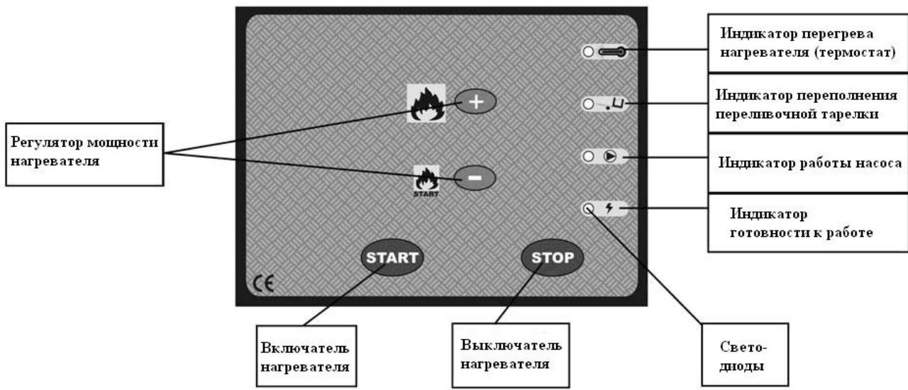
Рис.4. Вид панели переднего модуля управления нагревателя на универсальном масле.
