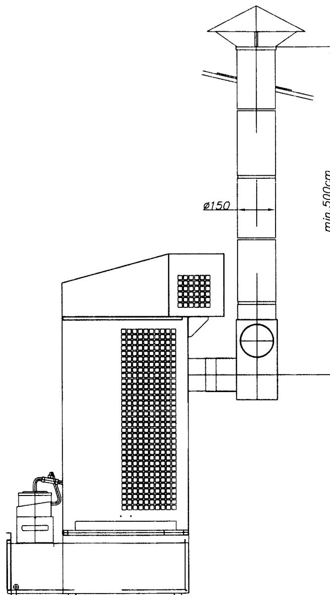
Рис.3. Монтаж дымоотвода
