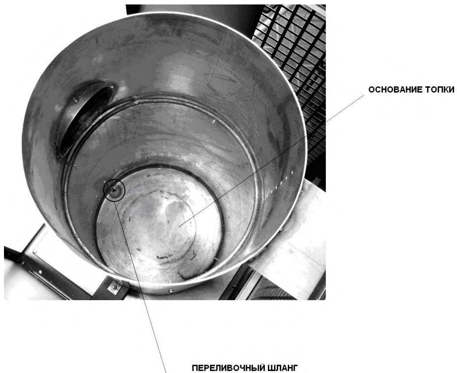
Рис.7. Камера сгорания
