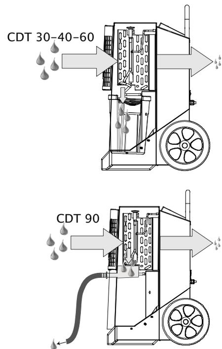
По мере того как воздух циркулирует через осушитель, его влажность постепенно снижается, что приводит к быстрому, но мягкому осушению. Осушитель может работать непрерывно или включаться и выключаться встроенным гигростатом.
